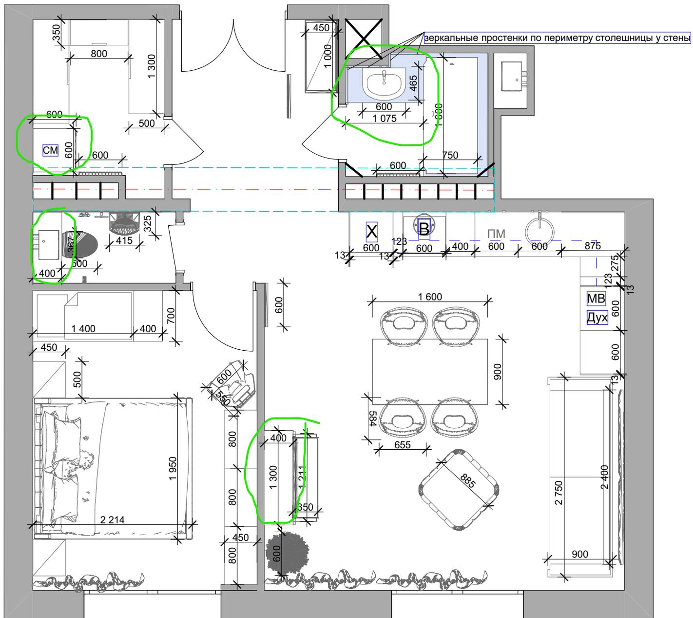
ПРИМЕЧАНИЕ: Размеры указаны по обмерам до реконструкции. Уточнить размеры после чистовой отделки.
